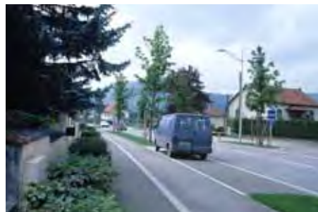
De gauche à droite : limite parcellaire, plantations arbustives, trottoir, piste cyclable, bande alternant stationnement et végétation, chaussée, etc.
