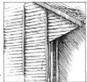
EXEMPLE DE BARDAGE HORIZONTAL GRANGE DE LA FORGE.
