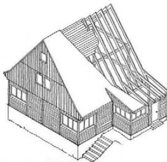
EN LIAISON AVEC LES DESTRUCTION DE LA GUERRE EST APPARU CET AUTRE PRINCIPE DE CONSTRUCTION EN BOIS PAR POTEAUX ET PANNEAUX.
